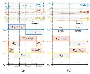
그림 2 한 스위칭 주기 동안의 상전류 파형 및 순시적으로 인가한 상전압과 영상분 전압. (a) 기존의 3 상 충전 방법 (b) 제안하는 2 상 충전 방법
