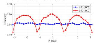
그림 5 회전자 위치  $\theta_r$ 에 따른 기존 3상 충전 방법(SC3)과 제안하는 2상 충전 방법(SC2)의 효율 측정 결과.
