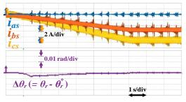
그림6  $\theta_{r,init}=0$  조건에서 2상 충전을 수행하는 경우,  $I_{ch}$ 를 0부터  $I_{rated}=15$  A 까지 증가시킬 때의  $\Delta\theta_{r}$  측정 결과.
