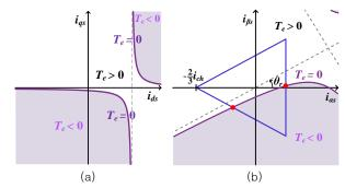
그림 3  $\partial \psi/\partial \theta_r < 0$  일 때 차동 모드 전류 평면 상의 토크. (a) 토크 부호 (b) 2 상 충전 시 토크가 0 이 되는 지점
