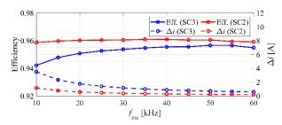
그림4  $P_{ch}=P_{rated}, \theta_r=0$  조건에서, 스위칭 주파수에 따른 기존 3상 충전 방법(SC3)과 제안하는 2상 충전 방법(SC2)의 효율 및 평균 상전류 리플  $\Delta i$  측정 결과.
